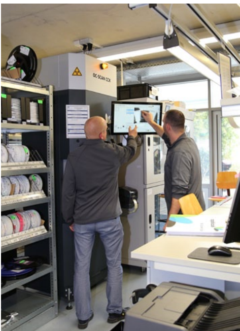
Der OC-SCAN@CCX ist bei Grüninger Electronics direkt in die Lagerlogistik eingebunden
